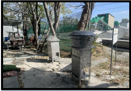
รูปที่ 2-2 การตรวจวัดคุณภาพอากาศและ เสียงโรงโม่หินของโครงการ
