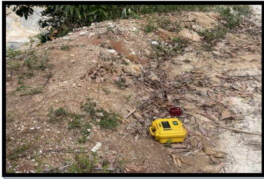
รูปที่ 2-6 การตรวจวัดความสั่นสะเทือนขอบประตูน้ำประปา
