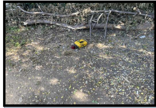
รูปที่ 2-7 การตรวจวัดความสั่นสะเทือนบนถนนที่ขอบประตูน้ำประปา
